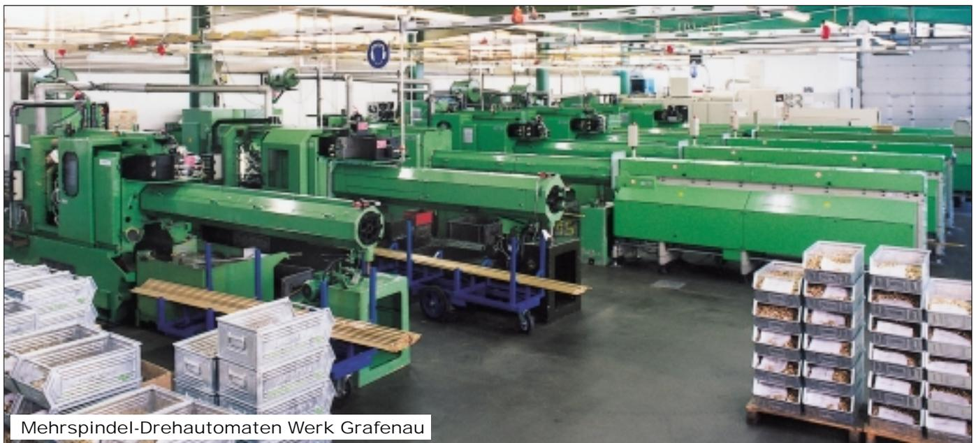
Mehrspindel-Drehautomaten Werk Grafenau
